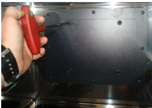
Figura nº19 - Acesso aos parafusos para retirar a tampa da escotilha
