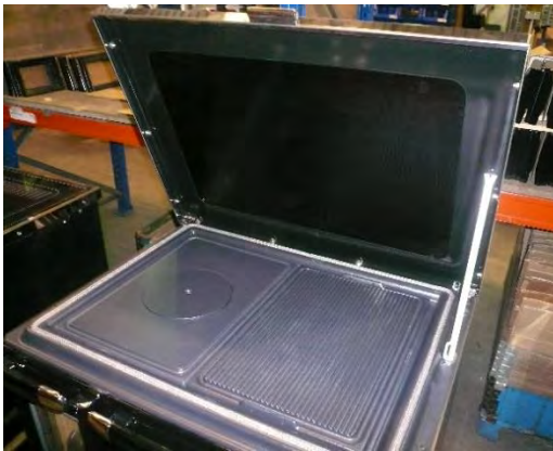
Figura n°17 - Protección bajo encimera vitrocerámica
