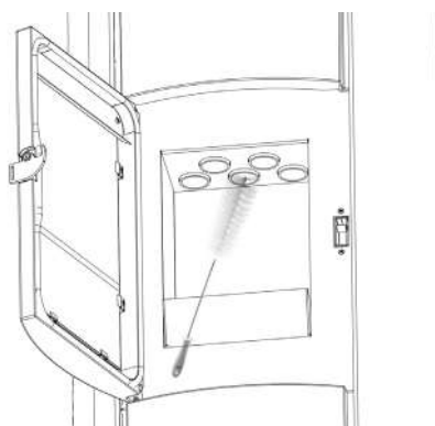
Fig. 22 - Limpeza do carcaça e tubos
