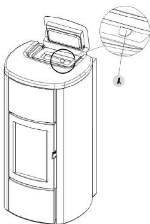
Fig. 20 - Alavanca para limpeza dos turbuladores (Idro Prince 3 16-23-23 H2O, Aquos 3 16-23-23 H2O, Idron 16-22 Airtight, Hidrofire 22.8)
