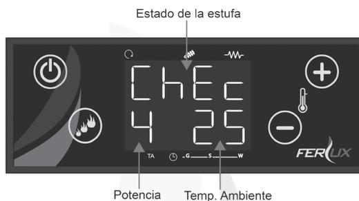
Neste momento, a placa realiza um controlo da estufa “ChEc” durante o qual realiza as verificações. Se durante esta verificação, a placa detetar qualquer anomalia, não arrancará e dará a mensagem de erro correspondente. Se tudo estiver correto, a estufa começa o processo de acendimento.
