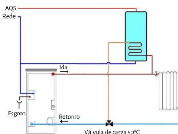
Instalação hidráulica com Acumulador para A.Q.S. e Válvula de 3 vias elétrica
